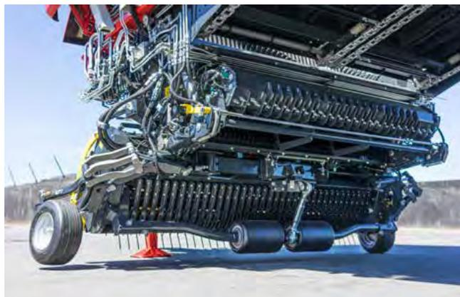
El rodillo adicional de la rueda palpadora del pick up de nuevo desarrollo está colocado de forma central detrás del pick up. La posición central evita el hundimiento en las huellas del tractor y garantiza una perfecta adaptación al suelo.
